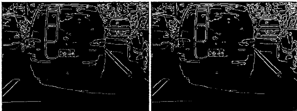
(a) Canny 에지를 적용한 영상 (b) 소실점을 향하는 에지 차선 성분 (a) Canny edge image (b) Road lanes toward the vanishing point
