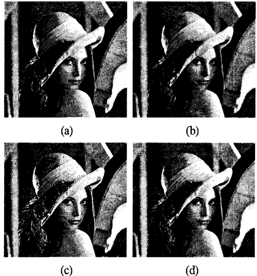
그림 5. LENA 영상에 대한 실험결과(512x512) (a)원영상 (b) 미디안 필터링 (c) 고주파 통과 필터 (d) 제안한 필터 Fig. 5. Result of LENA image(512x512) (a) Original image (b) Median filtering (c) Highpass filtering (d) Proposed algorithm
