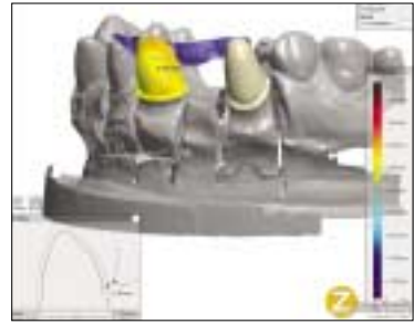
⑤ Core 두께 설정 및 표면 추가/삭제 (두께 표시, 2D 단면기능으로 대합 치와의 거리 및 디자인 확인가능)
