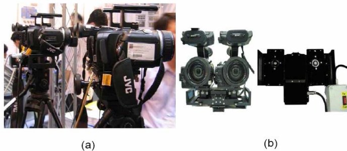
그림 12. 고화질 다시점 비디오 전송 시스템: (a) 다시점 카메라 구성, (b) 고화질 입체 비디오를 위한 카메라와 마운트 카메라 구성 Fig. 12. Camera configuration for multi-view HD video transport system: (a) multi-view camera configuration and (b) camera and mount for stereoscopic HD video
