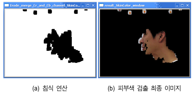
그림 4. 측면 얼굴 영역 검출 알고리즘 2 Fig 4. Side face region detection algorithm 2: a) Erode operation, b) Skin color detection result
