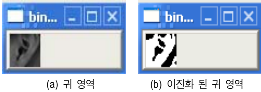
그림 9. 귀 영역 및 이진화 Fig 9. Ear region and Binary image: a) Ear region image , b) Binary image
