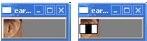
그림 6. 귀 영역에서 Haar-like 특징의 예 Fig 6. Example of Haar-like feature in ear region
