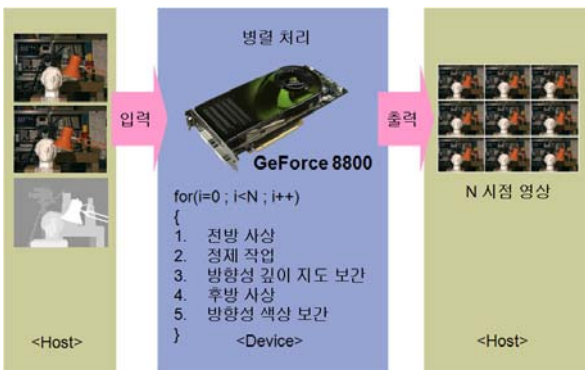
그림 19. 영상 합성 개략도 Fig 19. Overview of parallel view synthesis
