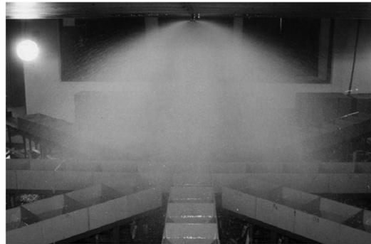
그림 5. 표준형헤드 살수분포 시험(방사압력 0.1 MPa)
