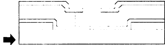
· 게이트 헤드 부분 패터닝을 위한 1차 전자 빔 → 1차 현상 → 게이트 푯 형성을 위한 2차 전자 빔 묘화 → 2차 현상
