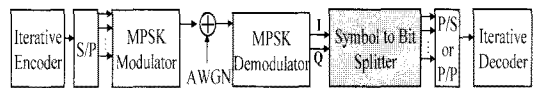
그림 1. 멀티 레벨 변조를 위한 시스템 블록도 Fig. 1 System block diagram for multilevel modulation
