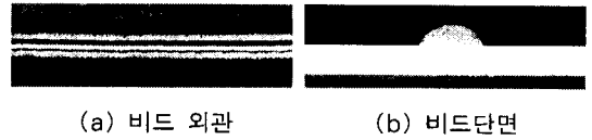
그림 22. 제안된 중첩교류 펄스 용접 전원의 비드(90(A)) Fig. 22. Bead of proposed superposition ac pulse welding(90(A))
