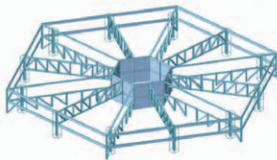
기존의 사각형 평면 넓막하고 정육각형 평면구성 적용 Staggerd Truss 사용하여 6개의 날개 형성 적은 재료를 사용하여 강성을 증대 시키고 대공간 창출
