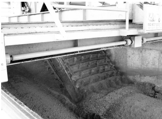
▲계분(우)은 컨베이어벨트를 통해 계분처리장으로 이동되고, 강남시스템의 '수분조절제 절약형 교반기'를 통해 유기퇴비 효과 재생산된다(좌). 인력감소는 물론 위생적인 계사환경을 유지하는데 일조한다.
