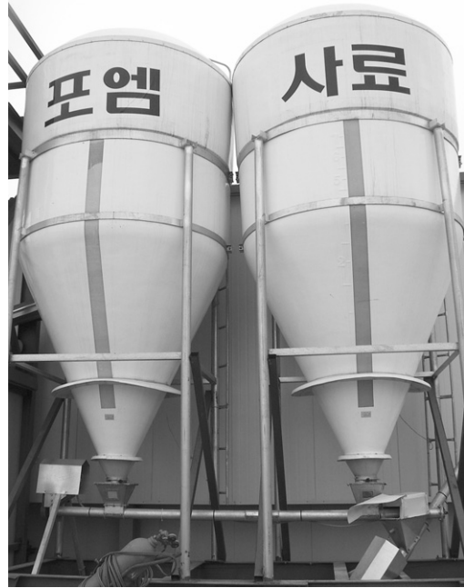
▲홍성학 대표는 지난 2005년부터 포엠사료를 설립해 OEM 방식으로 제조·판매하고 있다. 사료 제품에 따른 계군의 섭취량을 기록하기 위해 사료 bin에 저울을 장치하여 사료 급이량을 자동 체크할 수 있다.
