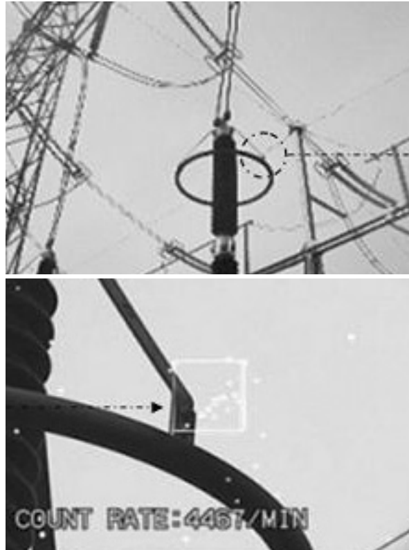
그림 4. 345 kV 피뢰기의 Grading Ring에서 나타난 코로나 방전현상
