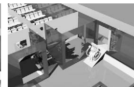
Fig. 35 중앙부 현문 경사판 설치
