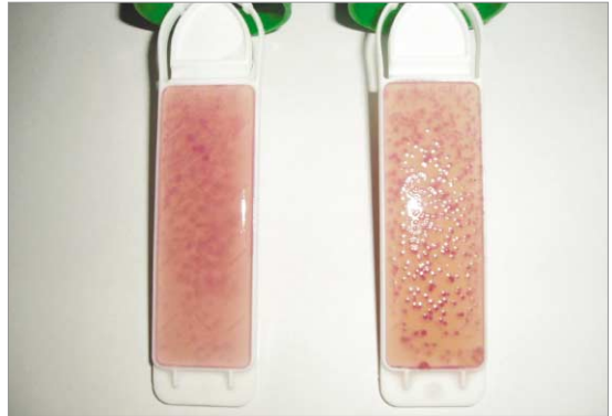
〈그림 2〉 급수기내 물 채취후 진단키트 검사 결과
