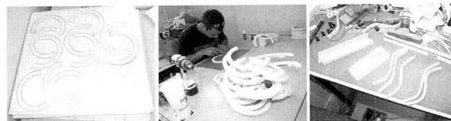
(그림 4) CNC milling machine을 이용하여 기본 단위부재를 만드는 모습과 여러 겹의 얇은 판 부재를 결 방향이 평행하게 접착시켜 부재를 만드는 모습
