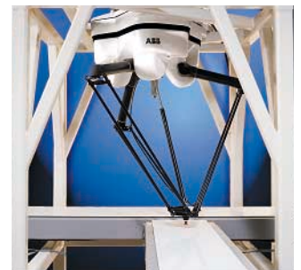
거미 다리처럼 생긴 세계에서 가장 빠른 로봇이다. 1초에 10m를 이동하며, 10바퀴 돈다. 스웨덴 ABB사의 '플렉스 피커'.
