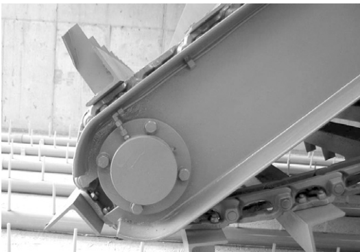
▲ 구리스 자동주입장치 기계결함을 방지하기 위해 수작업으로 진행하던 윤활류 주입에서 구리스 자동주입장치를 특허 발명하면서 인력감소는 물론 기계의 잔고장을 방지하는 효과를 보고 있다.
