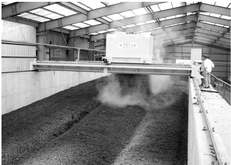
▲강남시스템에서 생산되는 '수분조절제 절약형 교반기'. 80℃의 발효열로 유해물질을 파괴하고 에스컬레이터 방식으로 2m 높이로 쌓인 계분을 유기퇴비로 만들 수 있다.
