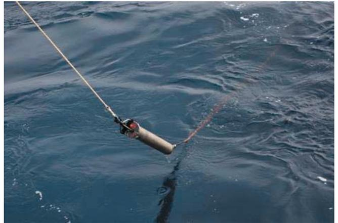
남극 브랜스필드 지역에 설치, 일년 동안 관측한 수중 청음기를 회수하는 모습
