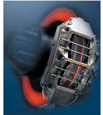
고온에서 진행되는 브레이크 시험 사진 (온도가 800℃까지 상승한다)
