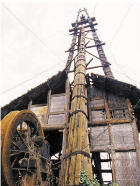
스촐성 찌공(自貢)에 남아있는 염정에 사용되던 대나무관다발과 기중기의 모습 및 아직도 옛 방식으로 소금을 줄이는 모습
