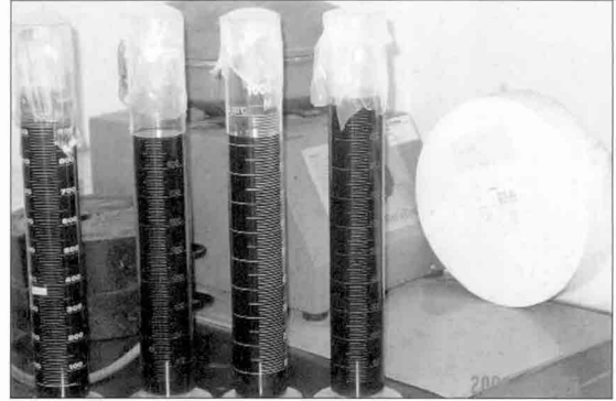
[사진 6] 추출시험 후 삼염화에틸렌에 용해된 아스팔트
