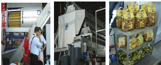
감자 세척, 크기별 분류, 포장 장치 및 소포장된 감자
