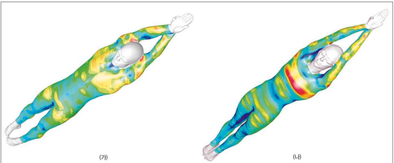
시뮬레이션을 통해 계산된 미끄럼 동작 중의 저항 분포: 남자 선수(가), 여자 선수(나) (사진 출처: Barry Bixler 및 Speedo)
