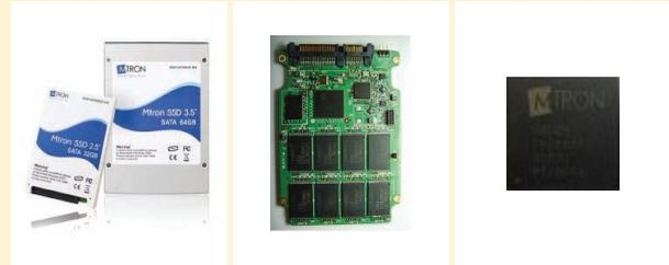
수준의 성능을 자랑합니다. 일반적으로 플래시 메모리의 쓰고 지우기 횟수는 10만 번으로 제한되어 있습니다. 하지만 엠트론 SSD는 Wear-leveling 알고리즘, 7bit ECC (Error Correction Code) 및 bad block management의 기술력으로제품의 수명 기간을 140년 이상으로 연장시켰습니다.
