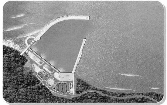
그림9. 아치형 다기수로를 가진 해수교환 방파제
