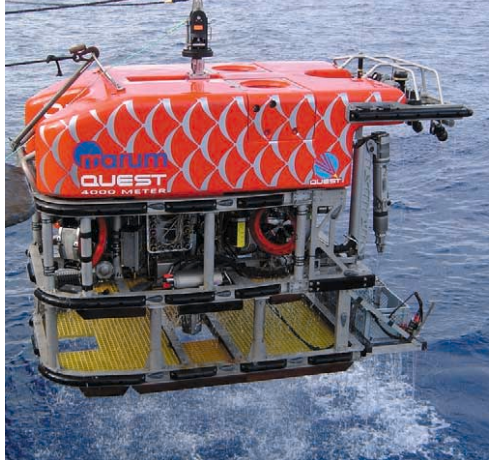
링 추진기를 장착한 4천m급 QUEST ROV (ASR사 제작, 독일 브레멘 대학 Marum 소유)
