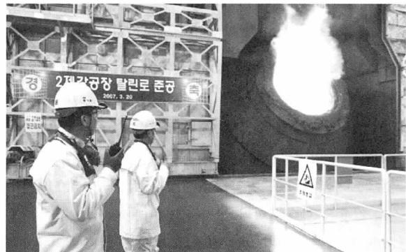
설비 규모에서도 300톤 탈린전로 1기, 450톤 용선기중기 1식, 배가스 처리설비 1식, 부원료 수송 및 투입설비 1식, 수처리 및 집진설비 각 1식 등 하나의 단일공장 신설과 거의 맞먹는 수준이다. 탈린전로는 용선 중의 인(燐)성분을 최대한 하향화해 API재나 TMCP재 등 품질향상을 통한 극저린 고급강의 양산이 가능하며, 기존의 전로 대비 부원료(생석회) 사용량을 15% 줄여 원가절감 및 친환경 조업체제를 갖추게 된다. 포항제철소 2제강공장은 이번 탈린전로 준공으로 조강 1천만톤을 생산할 수 있는 세계최고의 설비능력을 갖췄을 뿐만 아니라, 고급강을 양산하고 원가를 절감할 수 있는 인프라를 구축했다.
