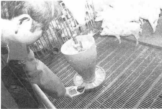
▲ 미생물 소독제를 사용한 돈사는 암모니아 함량이 1~3ppm으로 측정되었고 일반 화학소독제를 사용한 돈사는 같은 조건에서 암모니아 함량이 10~24ppm으로 높게 나타났다. 이렇게 김영석 이사는 끊임없이 개선점을 찾아 적용하고 있다.
