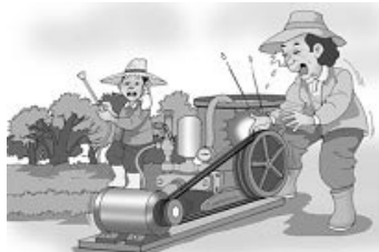
〈전원 차단 않고 벨트 점검하다 손가락 절단〉
