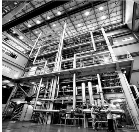
세하게 축소 제작해서, 원자력발전소에서 일어날 수 있는 다양한 사고와 고장을 실제 압력과 온도로 시뮬레이션할 수 있는 가압경수로 열수력 종합 효과 실험 장치 '아틀라스(ATLAS; Advanced Thermal-Hydraulic Test Loop for Accident Simulation)'의 구축과 시운전을 완료하고 본격 가동 중이라고 밝혔다.
