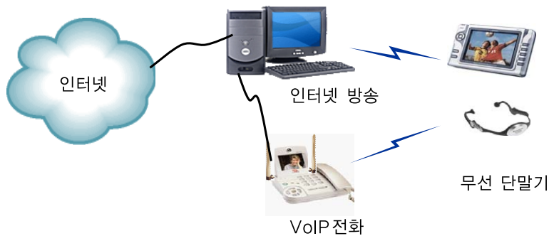
그림 2. 인터넷 방송과 VoIP 전화기의 무선 융합 단말
