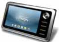
코원시스템(대표 박남규)이 동영상 재생능력이 탁월한 PMP 'COWON A3'를 출시했다. 이 제품은 모든 코넥트를 지원하며, 최대 1280X720 HD급 동영상까지도 별도의 인코딩 작업 없이 재생이 가능하다. PMP 최초로 0.108mm의 초 세밀 패널 피치를 구현한 1600만 컬러 LCD를 통해 보다 섬세하고 선명한 화질을 제공하며 고화질의 HD급 영상 출력이 가능하여 TV out 기능으로 디지털 TV와 연결하면 보다 생생한 화면을 즐길 수 있다. 또한 DMB, 1SEG, DVB-T 등 전 세계 모바일TV 방송을 지원하여 해외에서도 고화질의 TV방송을 시청할 수 있다. MP3, WMA, OGG, WAV, FLAC, APE, AC3 등 다양한 오디오 코덱을 지원하며, 전문오디오기기 수준의 10밴드 EQ와 코원 고유의 BBE 기능이 탑재된 '제트아펙트'를 통해 실감나는 사운드를 체험할 수 있다.
