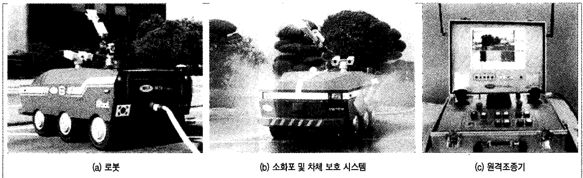
그림 6 실외화재진압 및 인명구조 로봇 개발 사례
