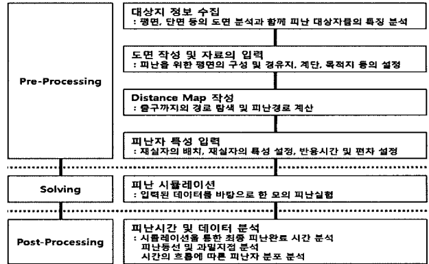
그림 7. 피난 시뮬레이션의 프로세스 (SimuleX)
