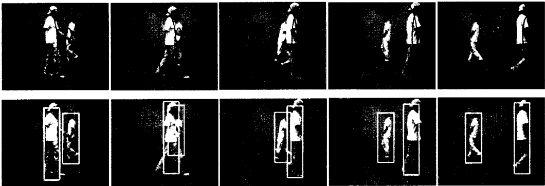
그림 6 (위) mean shift 추적 결과 (아래) 제안하는 방법론의 추적 결과 (Test Set B)
