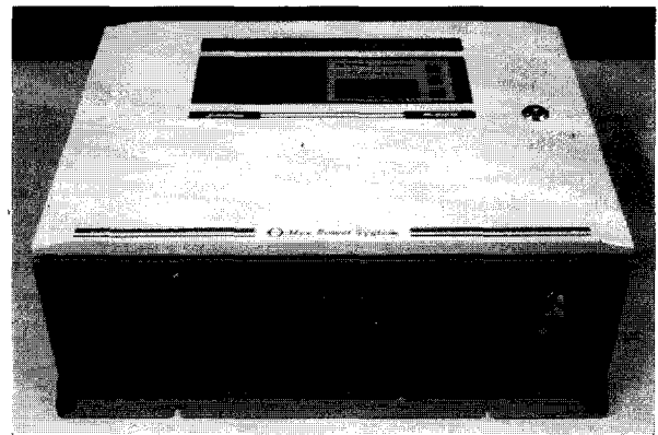
그림 4 비절연형 인버터 사진 Fig. 4 Outside of transformer-less inverter
