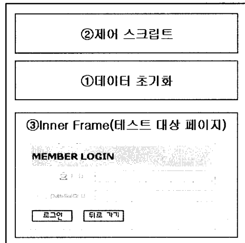
(그림 11) 사용자 입력 제어 기능 테스트를 위한 드라이버 구조
