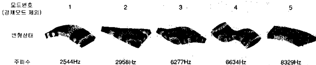
그림 1. 자유단 평판의 고유치 해석 결과: 저차 주파수로부터 1차 굽힘, 1차 뒤틀림, 2차 뒤틀림, 2차 굽힘과 같은 순서로 진동모드가 발생한다.
