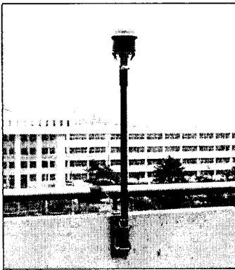
그림 5. 필드밀의 설치 Fig. 5. Installation of the prototype field mill
