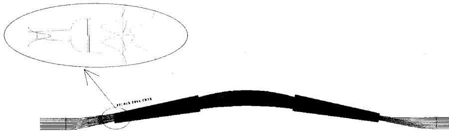
그림 1. 나팔형태 도파로를 가진 PLC-CWDM 소자의 개략도.
