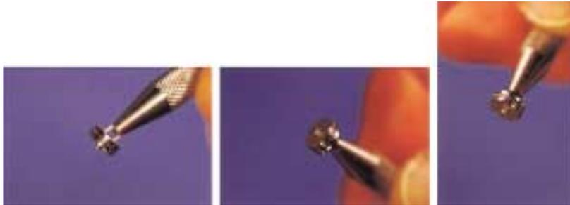
〈그림 43〉 Valve에 끼워진 processing cap
