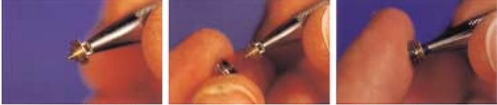
〈그림 42〉 Service key에 processing cap을 위치시킨 다음 그 위로 valve를 끼워 밀어 넣는다.
