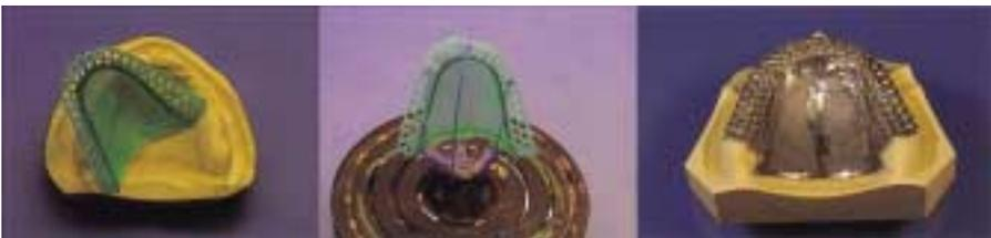
〈그림 7〉 주입선 설치 후 매몰, 주조
