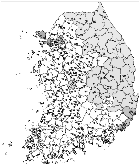
그림 1. GPS관측을 실시한 1·2등 삼각점 분포. ▲은 GPS 상시관측소를 나타냄.
