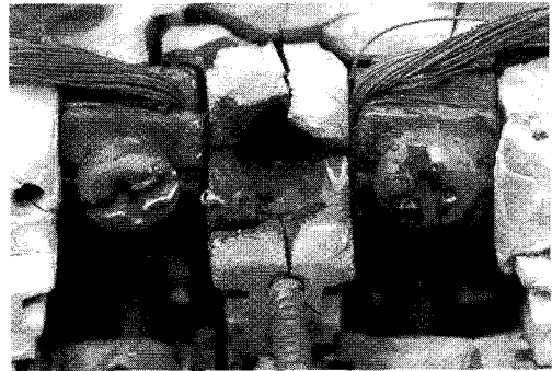
〈Figure 10〉 Figure 9의 □부분, 트래킹 형태 (전기적 용융흔, 탄화도전로).
