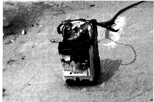
〈Figure 6〉 차단기 전원측 단자간 섬광이후에도 지속되는 스파크 현상.
