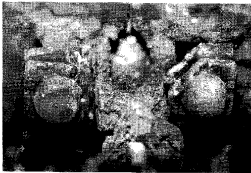
〈Figure 28〉 Figure 1의 □부분, 트래킹 형태 (전기적 용융흔, 탄화도전로).
