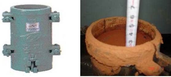
그림 1. 시험체 몰드 및 수축길이 측정
