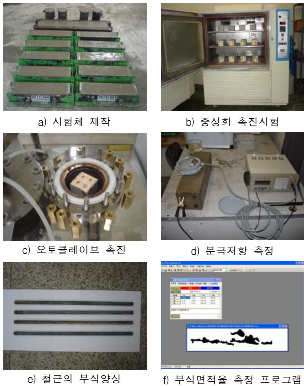
그림 3. 시험체 제작 및 부식 실험 전경
