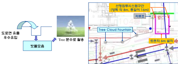
그림 12. 104동 인공지반 위 선형침투시스템 활용안
