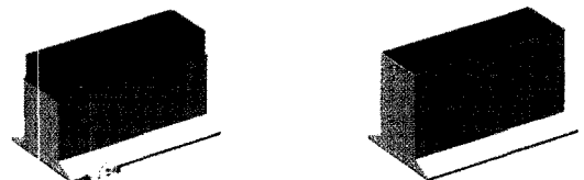
(d) 콘크리트 타설 (e) 강제케이스 완성
