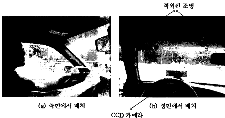
그림 3 차량 내 시스템 설치 모습
